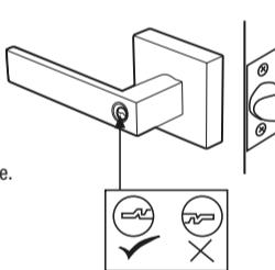
Nota: la manivela exterior no tiene tornillos visibles.
