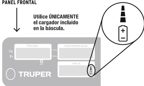
4. Cargue la batería conectando la báscula a la corriente eléctrica. Usted puede usar el equipo mientras se carga. Vuelva al paso 3 y repita el proceso continuamente.
