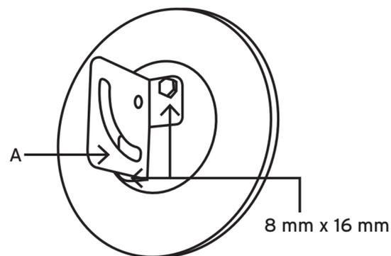
2. Fije los soportes "B" en la placa "A", utilizando dos tornillos de 8 mm x 16 mm, dos arandelas y dos tuercas M8. No apriete las tuercas.
