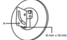
2. Fije los soportes "B" en la placa "A", utilizando dos tornillos de 8 mm x 16 mm, dos arandelas y dos tuercas M8. No apriete las tuercas.
