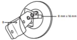
3. Fije el espejo en un poste, utilizando un tornillo 8 mm x 16 mm, un tornillo 8 mm x 25 mm, dos tuercas M8 y dos arandelas.
