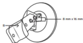
3. Fije el espejo en un poste, utilizando un tornillo 8 mm x 16 mm, un tornillo 8 mm x 25 mm, dos tuercas MB y dos arandelas.
