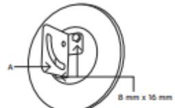
2. Fije los soportes "B" en la placa "A", utilizando dos tornillos de 8 mm x 16 mm, dos arandelas y dos tuercas MB. No apriete las tuercas.
