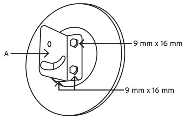
2. Fije los soportes "B" en la placa "A", utilizando dos tornillos de 8 mm x 16 mm, dos arandelas y dos tuercas M8. No apriete las tuercas.
