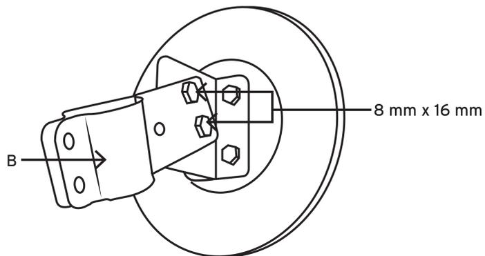
3. Fije el espejo en un poste, utilizando un tornillo 8 mm x 16 mm, una tuerca M8 y una arandela, dos tornillos 8 mm x 25 mm, dos tuercas M8 y dos arandelas.
