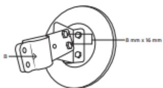
3. Fije el espejo en un poste, utilizando un tornillo 8 mm x 16 mm, una tuerca M8 y una arandela, dos tornillos 8 mm x 25 mm, dos tuercas M8 y dos arandelas.
