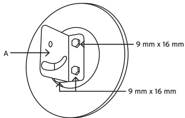
2. Fije los soportes "B" en la placa "A", utilizando dos tornillos de 9 mm x 16 mm, dos arandelas y dos tuercas M9. No apriete las tuercas.
