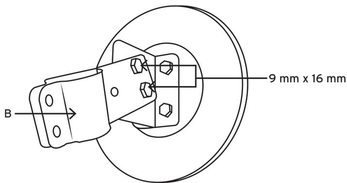
3. Fije el espejo en un poste, utilizando un tornillo 9 mm x 16 mm, una tuerca M9 y una arandela, dos tornillos 9 mm x 25 mm, dos tuercas M9 y dos arandelas.
