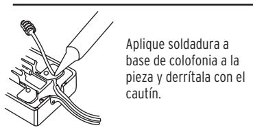
Aplique soldadura a base de colofonia a la pieza y derríttala con el cautín.
