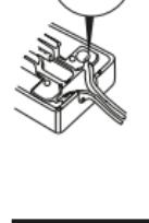
4. Espere a que la soldadura se enfrie y se endurezca antes de mover la pieza soldada
