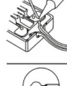
3. Aplique soldadura a base de colofonia a la pieza y derrítala con el cautín.
