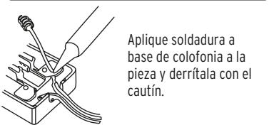
Aplique soldadura a base de colofonia a la pieza y derríitala con el cautín.
