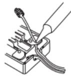
3. Aplique soldadura a base de colofonia a la pieza y derrítala con el soldador.
