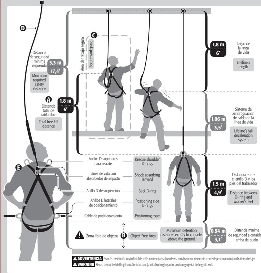
COLOCACIÓN DE LAS CONEXIONES
