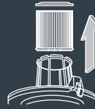
3. Deslice con cuidado el filtro de espuma hacia abajo sobre la jaula del filtro.
