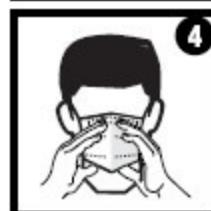
Usando ambas manos moldee la pieza plástica nasal a la forma de su nariz y área de las mejillas. Si se usa una sola mano se puede causar un mal sello, resultando en un funcionamiento deficiente del respirador.
