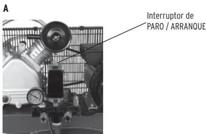
**NOTA:** Antes de arrancar el compresor, debe descargarse cualquier aire comprimido que haya permanecido arriba del pistón y en el tubo de alimentación, presionando el botón del interruptor de presión, y levantándolo nuevamente a la posición "I" (encendido). El motor arrancará inmediatamente.
