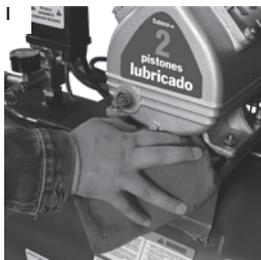
**LIMPIEZA:** Mantenga limpio el interior y exterior del compresor. Cambie el aceite regularmente, y mantenga limpias todas las superficies externas. Un interior limpio asegura una buena eficiencia mecánica, y un exterior limpio permite una disipación más eficiente del calor al aire circulante. Fig. I
