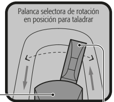
(E) Selector de impacto-rotación en posición de taladro
