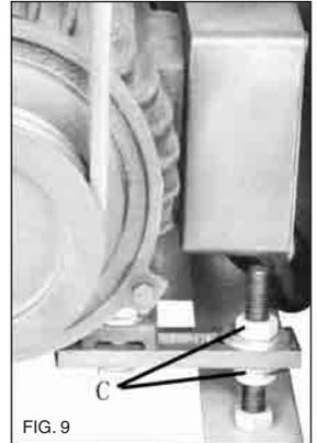
4. Instale las bandas en las dos poleas como se muestra en la Fig. 8, y ajuste las bandas a la tensión correcta levantando o bajando la placa del motor, como se muestra en la Fig. 9. Ahora apriete las tuercas (C), Fig. 9. La tensión correcta se logra cuando se tiene una deflexión de aproximadamente 6,3 mm - 1/4" en la parte central de las poleas al aplicar presión con los dedos.
