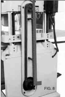
3. Usando una regla, alinee las poleas del motor y del cabezal de corte como se muestra en la Fig. 8; la placa del motor (B), Fig. 7, puede moverse para alineación aflojando los tornillos prisioneros (C) de la placa del motor (B) como se muestra en la Fig. 7.
