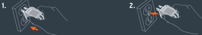
Sostenga e inserte el probador de circuito de tomacorrientes en el contacto como indica la flecha. No mueva los dedos a través de la línea de advertencia para impedir una descarga eléctrica.
