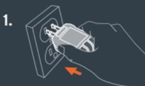
Sostenga e inserte el probador de circuito de tomacorrientes en el contacto como indica la flecha. No mueva los dedos a través de la línea de advertencia para impedir una descarga eléctrica.
