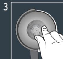
Coloque la contratuerca en la flecha de la máquina
