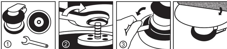
Coloque en el pad la lija de acuerdo al trabajo que desea realizar (use lijas para superficie de hook and loop)
