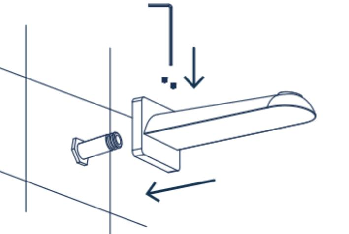
3. Inserte la salida de tina con el chapetón a la conexión y asegúrelos con los 2 tornillos de sujeción con ayuda de la llave allen.
