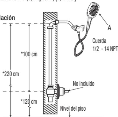
\*Medida recomendada. Coloque la regadera (A) Nota: En todas las uniones roscadas utilizar cinta teflón, para evitar fugas.
