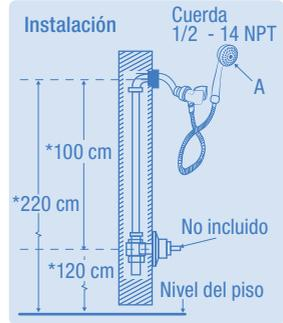
Medida recomendada. Coloque la regadera (A) Nota: En todas las uniones roscadas utilizar cinta teflón, para evitar fugas.
