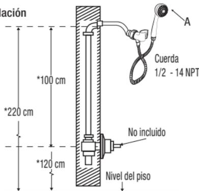
\*Medida recomendada. Coloque la regadera (A) Nota: En todas las uniones roscadas utilizar cinta teflón, para evitar fugas.
