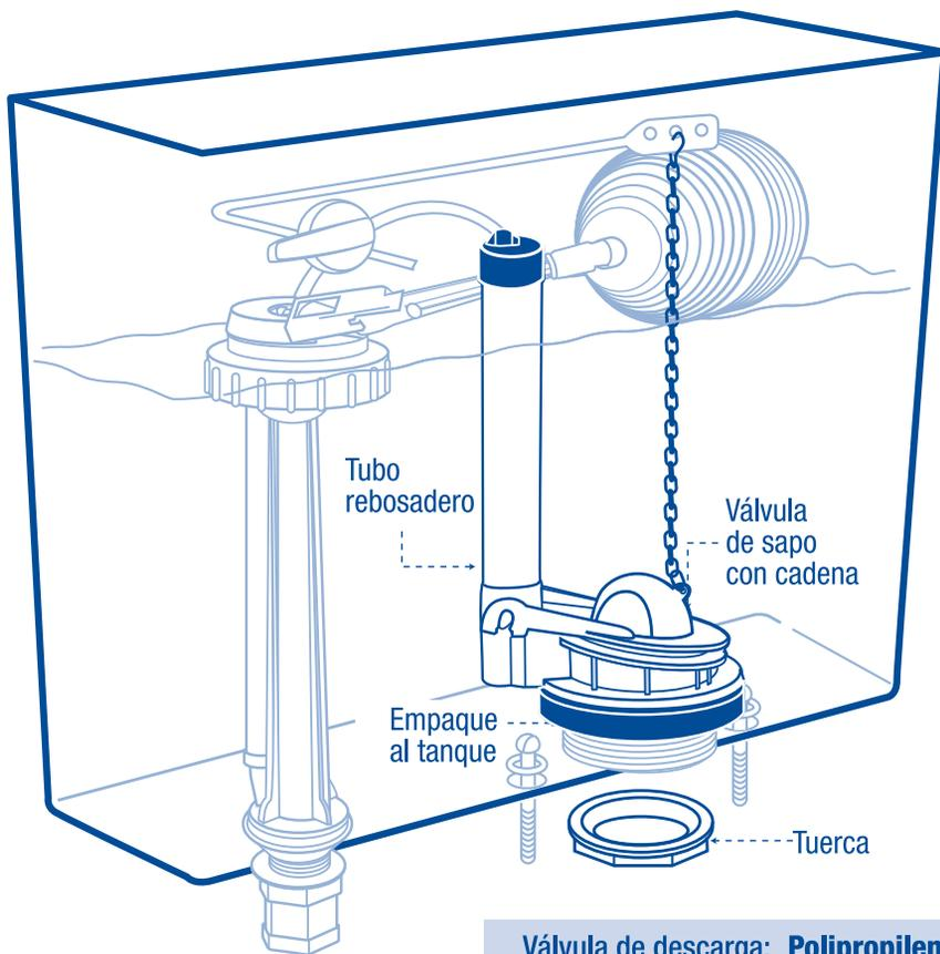
Válvula de descarga: **Polipropileno**
