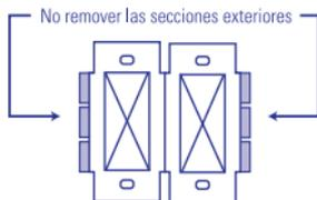
Cada control tiene secciones internas removidas
