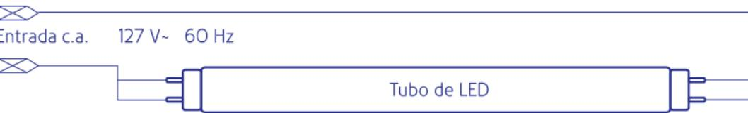
TECNOLOGÍA DE ENCENDIDO INSTANTÁNEO. No necesitan balastro, el uso del balastro daña el tubo.
