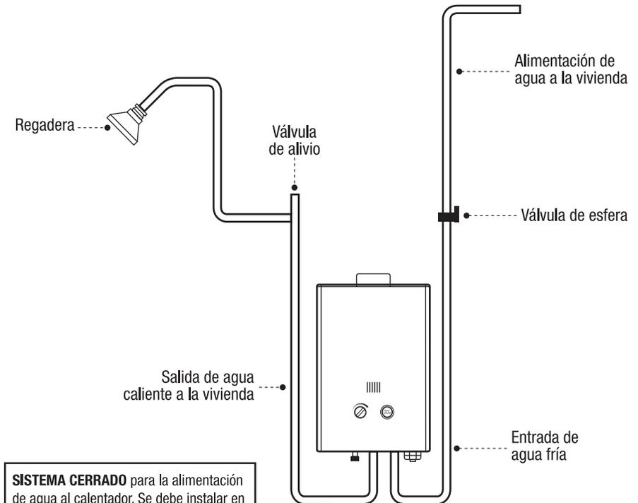
**SISTEMA CERRADO** para la alimentación de agua al calentador. Se debe instalar en la salida del agua caliente una válvula de alivio calibrada a 441,29 kPa (4,5 kg/cm<sup>2</sup>)
