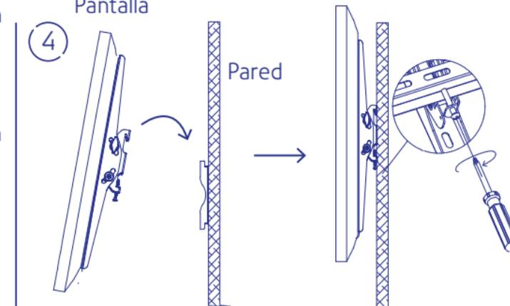
Coloque los ganchos que se fijaron a la televisión en el soporte de la pared y fíjelos con los dos tornillos de seguridad que están debajo de cada soporte.
