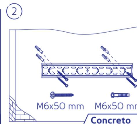
Coloque el soporte para pared y marque los cuatro puntos de perforación. Realice la perforación, coloque los taquetes y tornillos indicados.
