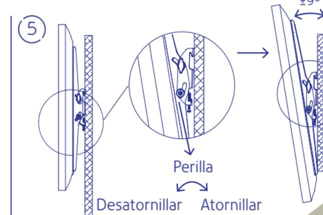
Ajuste el panel de televisión entre +9° y -9° a la posición adecuada. Finalmente, apriete los tornillos.
