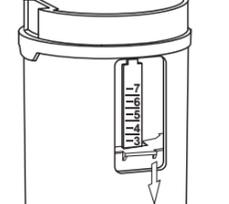
Para ajustar la altura del tubo de desborde, jale hacia abajo el seguro (a) para quitarlo. Ajuste la altura deseada del tubo de desborde (b). Coloque nuevamente el seguro (a) jalándolo hacia arriba.
