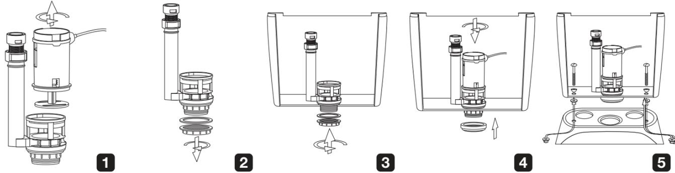
Sostenga la base de la válvula de descarga y gire en sentido contrario a las manecillas del reloj. Sáquela de la base.
