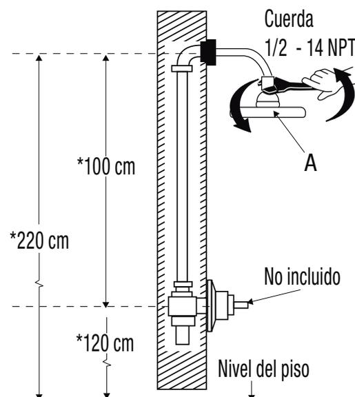
\*Medida recomendada. Coloque la regadera (A) Nota: En todas las uniones roscadas utilizar cinta teflón, para evitar fugas.
