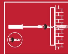
3. Instale las tuercas plásticas negras en los tornillos (como se muestra en la figura) coloque el perchero y atornille los tornillos con un desarmador.
