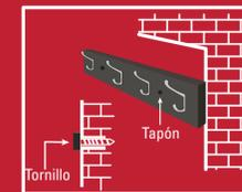
4. Una vez instalado el perchero, cubra las cabezas de los tornillos con los tapones decorativos de acero inoxidable. (Como se muestra en la figura). Solo presiónalo con la mano.
