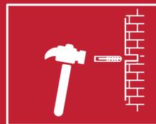
2. Inserte los taquetes en los orificios con un martillo, estos deben estar nivelados con la pared.
