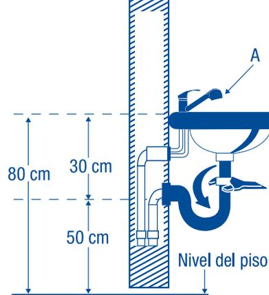
Medida recomendada. Coloque el monomando (A) Nota: En todas las uniones roscadas utilizar cinta teflón, para evitar fugas.
