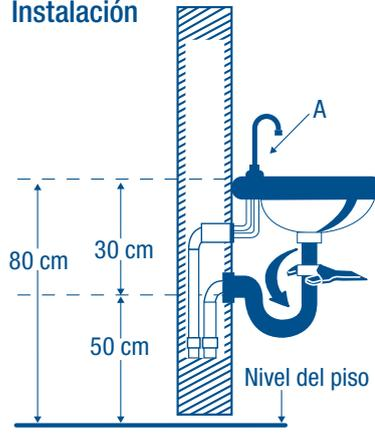
Medida recomendada. Coloque la mezcladora (A) Nota: En todas las uniones roscadas utilizar cinta teflón, para evitar fugas.
