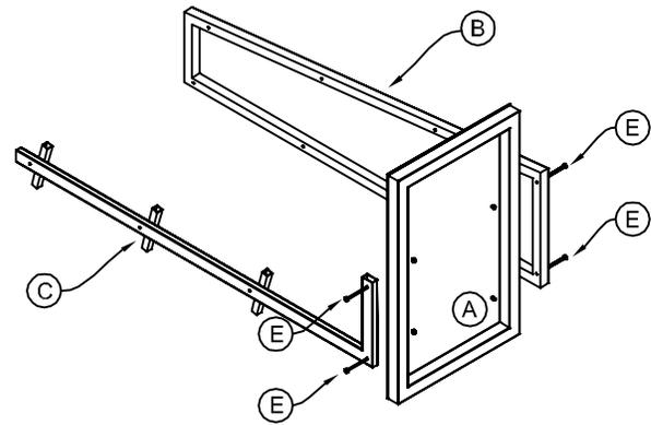
Como se muestra en el dibujo, la base (A) se gira para colocar el soporte lateral izquierdo (C), alinear los barrenos y fijar con 2 tornillos (E).
