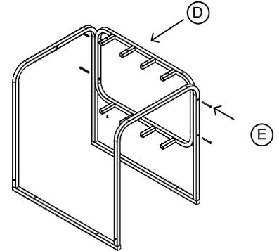
Colocar el soporte lateral (D) entre los soportes y fijar con los tornillos (E).
