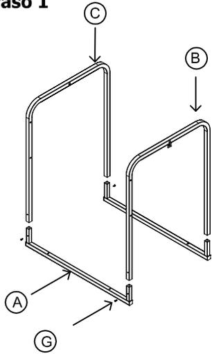
Para armar el rack, tomar las bases (A), y ensamblar los 2 soportes (B y C). Sujetarlos con las pijas (G)
