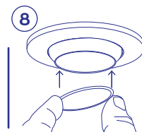
Agregue el clip de seguridad
