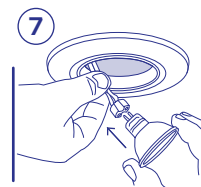
Conecte la lámpara al portalámparas
