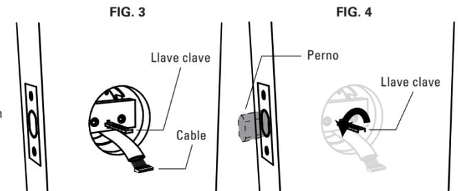
5. Quite la placa de montaje del cuerpo trasero y colóquela en el orificio de la puerta. Asegúrese de que el cable a través de la puerta este cerca de la placa de montaje (Ver detalle A). Fije la placa de montaje con el cuerpo frontal con los dos tornillos M6\*50 mm como se muestra en la FIG.5 y de forma opcional coloque el tornillo ST3.5\*20 mm para asegurar la placa de montaje a la puerta. Ver FIG.5
