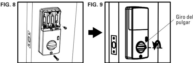
10. El pestillo del cerrojo se puede extender cuando gira el pulgar de horizontal a vertical, lo que significa que la cerradura está correctamente instalada.
