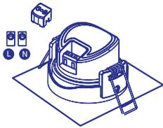
Conecte el cable de alimentación con el cable de entrada. Asegúrese de que ningún cable quede expuesto.
