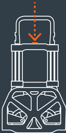
Presione el botón localizado a la mitad de la estructura del diablo
