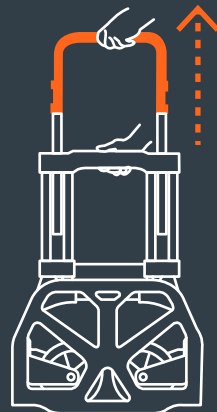
Jale hacia arriba el mango telescópico para aumentar la altura
