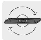
Cuchilla con diseño aerodinámico con filo de 25° para un corte fácil y preciso
