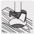
Orificios con fondo plano
