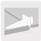
Para nivelar losetas de diferente espesor
