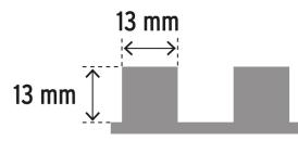
Especial para la aplicación de cementos o adhesivos en la colocación de losetas de gran formato, permitiendo la salida de aire para un mayor agarre y mayor duración.
