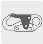
Resistencia de linguete: 3,600 lb (16 kN)
