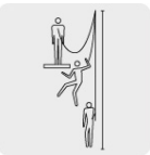
Distancia mínima al suelo desde el punto de anclaje 6 m
