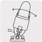
Capacidad de biselado 0 - 45° por ambos lados
