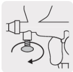
Válvula que regula la presión de aire
