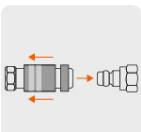
2 Conexiones rápidas de autobloqueo
