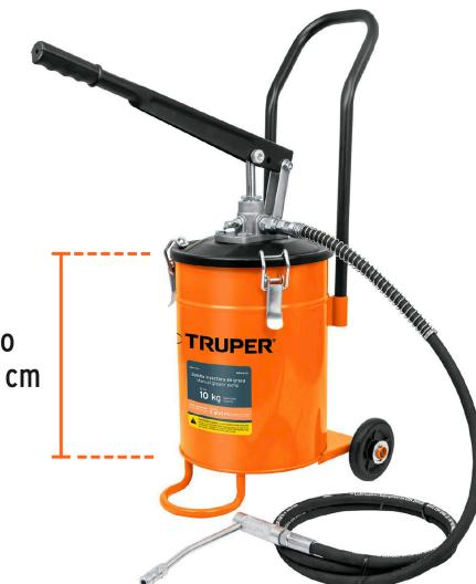
**! PARA PURGAR EL EQUIPO.** Accione la palanca varias veces para extraer el aire atrapado hasta llevar la grasa a la boquilla de la manguera. Coloque la manguera dentro del depósito para que la grasa inyectada no se tire sobre el piso.
